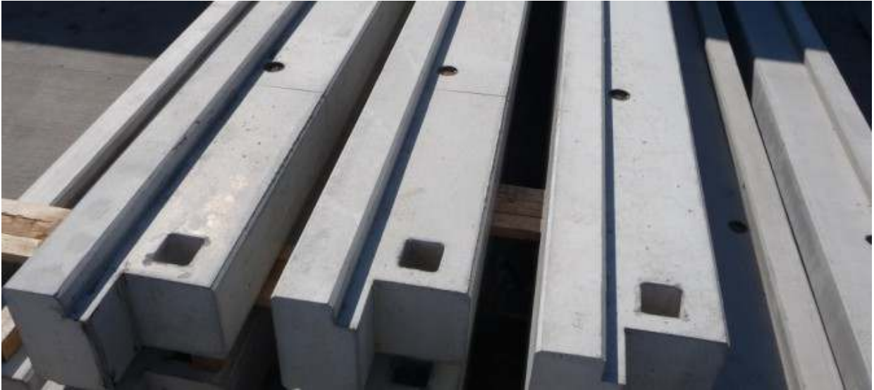
Fig: RCC beams
